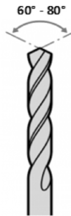
Rys.3 Zalecany kąt wiertła
