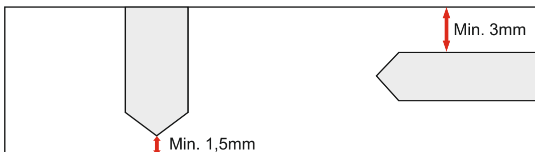
Rys.2 Odległość otworów od krawędzi
